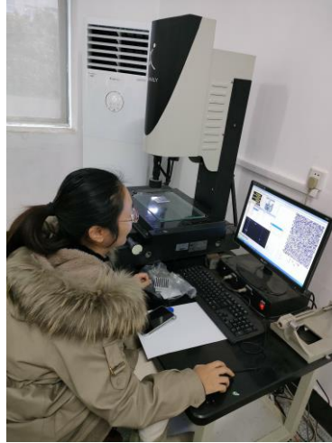
图 4 使用光学影像测量仪测量林格曼黑度图板
